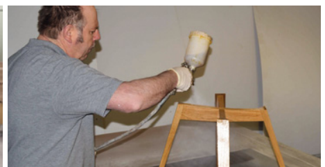
Stuhlgestellfertigung bei Maderas Holztechnik. Letzter Arbeitsschritt ist das Auftragen des Öls mit der Spritzpistole
