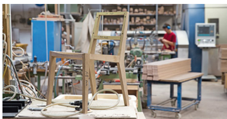
Stuhlgestellfertigung bei Maderas Holztechnik. Letzter Arbeitsschritt ist das Auftragen des Öls mit der Spritzpistole
